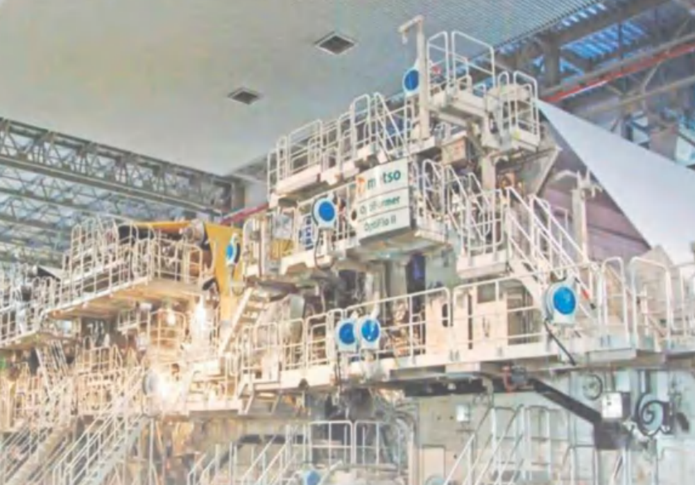
烘干部&施胶压榨 加热干燥&胶液的涂布
