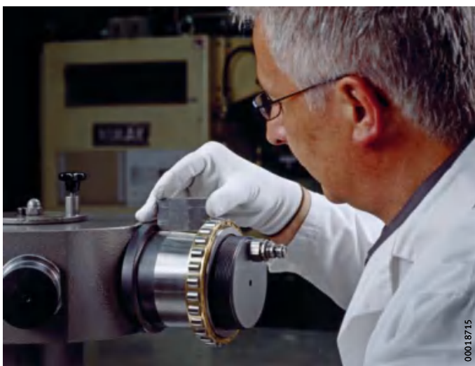
图 4 测量轴承内圈到轴肩的距离
