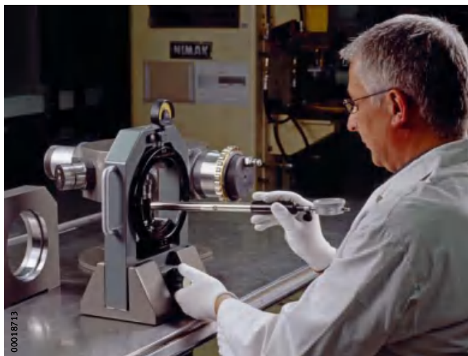
图 2 将测得的直径传递给包络圆测量仪
