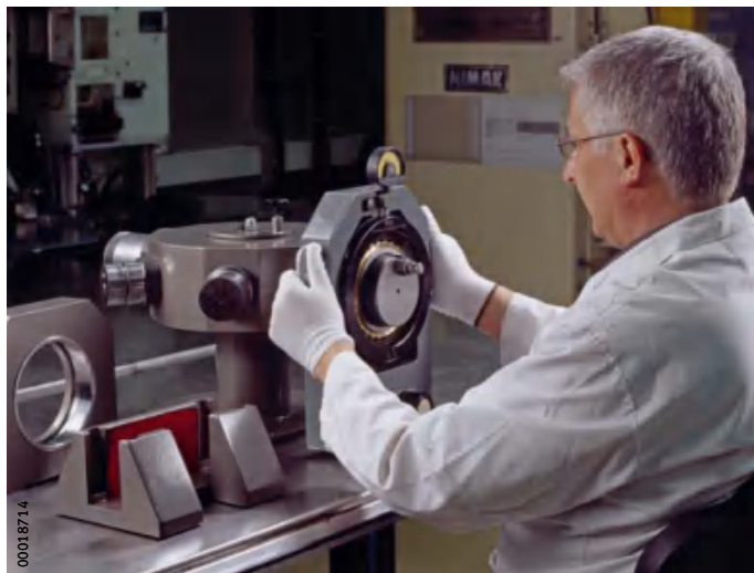
图 3 放置包络圆测量仪
