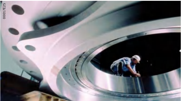
图 3 大型滚动轴承的安装
