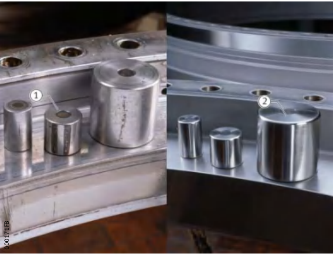
① 修复前： 滚子和滚道上有腐蚀痕迹和异形凹痕。 ② 修复后： 滚道经过重新研磨，新的滚子大小匹配
