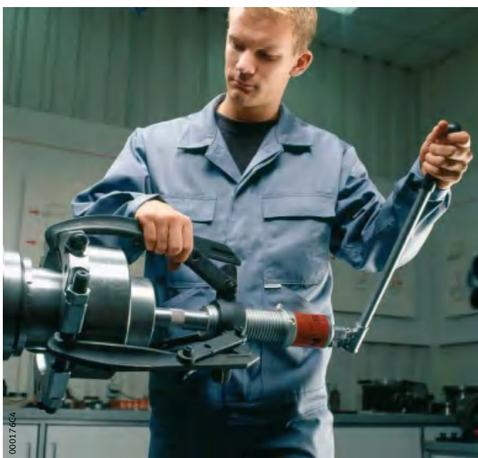
图 1 采用液压拉拔器拆卸轴承
