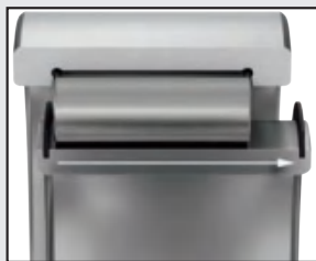
内外圈相对移动吸收轴向伸长
