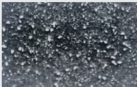
碳化物和碳氮化物在Super-TF轴承内的分布。(X4000放大倍率)
