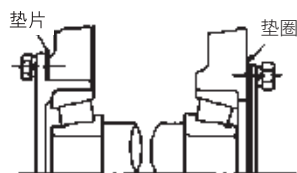
图8.27 在压盖内装入外圈的游隙调整实例
