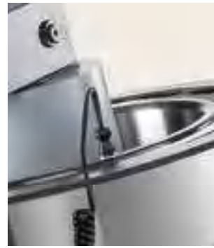
磁性温度探头装到内圈上，防止轴承加热过头
