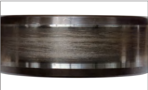
照片 4-1 部位：圆柱滚子轴承的内圈 损伤特征：沿滚道面圆周方向出现轻微擦伤 原因：润滑脂填充过多而引起滚子打滑
