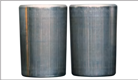
照片15-2 部位：照片15-1中的圆锥滚子 损伤特征：滚动面上出现条纹状电蚀现象
