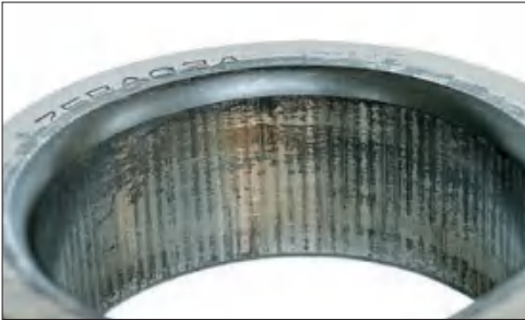
照片11-2 部位： 角接触球轴承的内圈 损伤特征： 整个内径面圆周上出现显著的微动磨损 原因： 过盈配合不足
