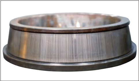
照片15-1 部位：圆锥滚子轴承的内圈 损伤特征：滚道表面上出现条纹状电蚀现象
