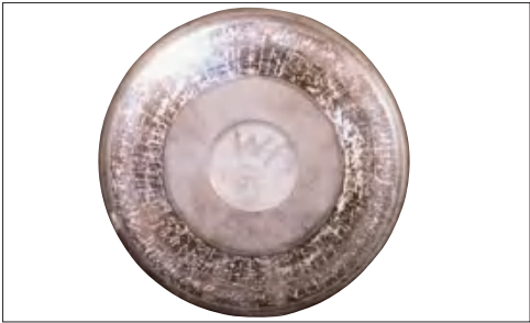
照片 6-2 部位： 推力圆锥滚子轴承的滚子 损伤特征： 滚子大端面出现热裂纹 原因： 由于润滑不良，与内圈挡边发生打滑导致异常发热
