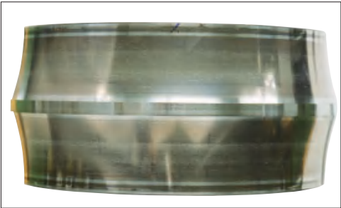
照片 4-3 部位：调心滚子轴承的内圈 损伤特征：沿滚道面圆周方向出现轻微擦伤 原因：润滑不良
