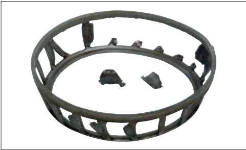
照片 7-4 部位：圆锥滚子轴承的保持架 损伤特征：钢板冲压保持架的梁折断
