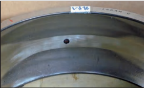
照片 10-3 部位： 调心滚子轴承的外圈 损伤特征： 滚道面承载区出现磨损 原因： 低速、重载、润滑不良（油膜破裂）
