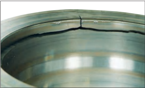
照片 6-3 部位： 双列圆柱滚子轴承的外圈 损伤特征： 以滚道面上的剥落为起点，沿轴向与圆周方向产生的断裂 原因： 由冲击压痕造成的剥落发展所致
