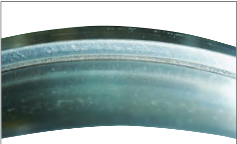
照片3-1 部位： 调心滚子轴承的内圈 损伤特征： 内圈挡边面出现擦伤 原因： 急加减速造成滚子打滑
