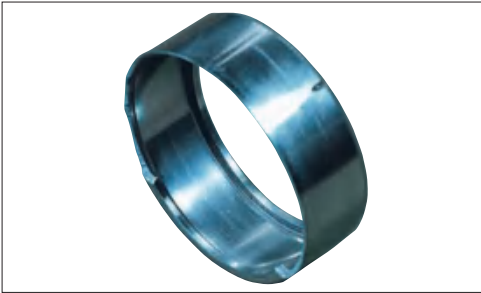
照片 5-4 部位： 实体滚针轴承的外圈 损伤特征： 外圈挡边上出现断裂 原因： 载荷过大导致滚子倾斜 （相比其直径，滚针较长。载荷过大或载荷不均的情况下，滚子倾斜挤压挡边）
