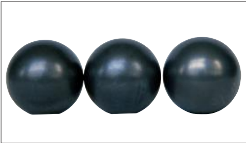
照片15-4 部位：深沟球轴承的钢球 损伤特征：深色的电蚀遍布整个球面
