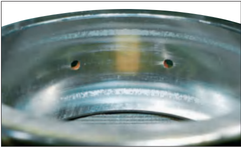
照片2-4 部位： 调心滚子轴承的外圈 损伤特征： 滚道整周出现剥皮现象 原因： 润滑不良
