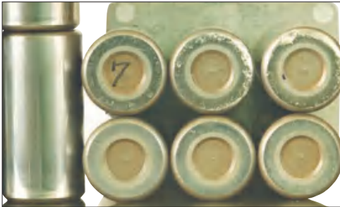
照片3-4 部位： 双列圆柱滚子轴承的滚子 损伤特征： 滚子端面出现擦伤 原因： 润滑不良且轴向载荷过大
