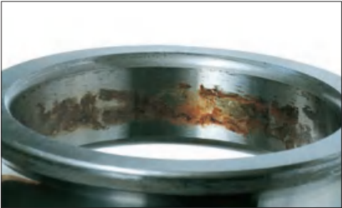
照片11-1 部位： 深沟球轴承的内圈 损伤特征： 内径面上出现微动磨损 原因： 振动
