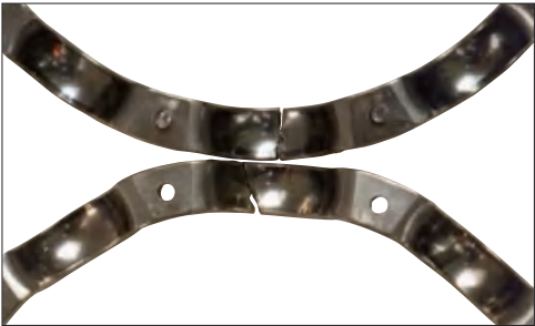
照片 7-1 部位：深沟球轴承的保持架 损伤特征：钢板冲压保持架的兜孔折断
