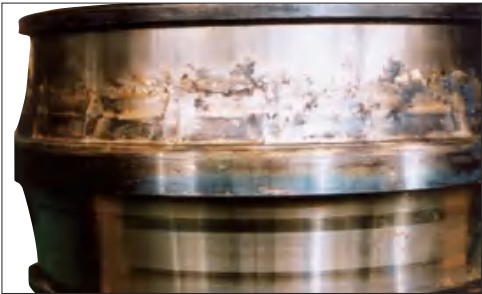
照片13-1 部位: 调心滚子轴承的内圈 损伤特征: 滚道变色, 出现熔融现象。保持架上的磨损颗粒被碾压、附着在滚道上 原因: 润滑不足
