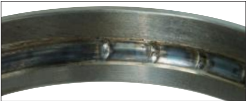
照片13-4 部位: 照片13-3中的外圈 损伤特征: 滚道变色, 出现呈等球距分布的熔融痕迹 原因: 预紧过大
