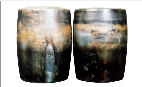
照片13-2 部位: 照片13-1的球面滚子 损伤特征: 滚子滚动面变色, 出现熔融现象, 附着有保持架上的磨损颗粒 原因: 润滑不足
