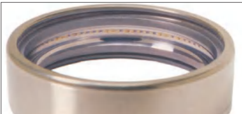
照片15-6 部位：深沟球轴承的外圈 损伤特征：滚道表面出现槽纹（高频）
