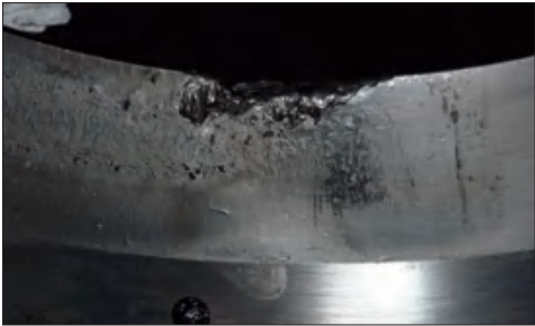
照片 10-4 部位： 调心滚子轴承的外圈（放大图） 损伤特征： 滚道面上出现细小的剥落和磨损 原因： 润滑不良导致油膜破裂，从而造成磨损（初次损伤），进而发展成剥落（二次损伤）
