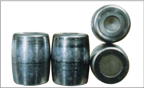
照片2-3 部位： 照片2-1的球面滚子 损伤特征： 滚动面中央出现圆形剥皮图案 原因： 润滑不良
