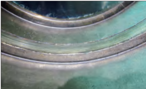
照片3-2 部位： 双列圆柱滚子轴承的外圈 损伤特征： 外圈挡边面出现明显的擦伤 原因： 轴向载荷过大
