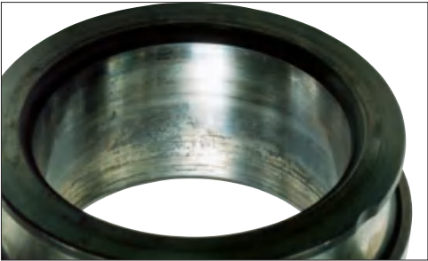
照片14-1 部位：调心滚子轴承的内圈 损伤特征：内径面上的蠕变，伴随有擦伤 原因：过盈量不足
