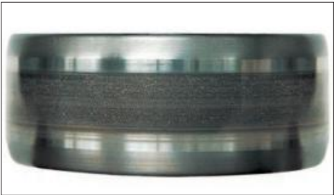
照片15-3 部位：圆柱滚子轴承的内圈 损伤特征：滚道表面上出现带状电蚀，并伴有凹坑
