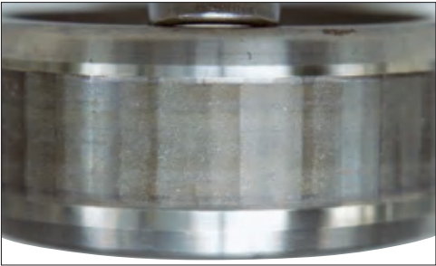
照片 10-1 部位： 圆柱滚子轴承的内圈 损伤特征： 因电蚀和波状磨损使滚道表面上出现许多凹坑 原因： 电蚀
