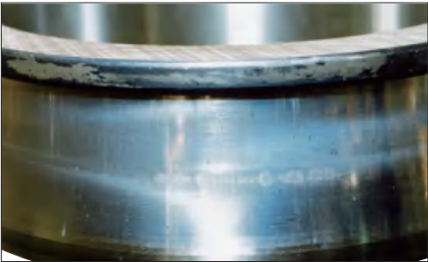
照片2-1 部位： 调心滚子轴承的内圈 损伤特征： 滚道面中央出现圆形剥皮图案 原因： 润滑不良
