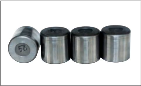
照片17-3 部位：圆柱滚子轴承的滚子 损伤特征：滚动面上产生的轴向伤痕 原因：安装时内、外圈倾斜
