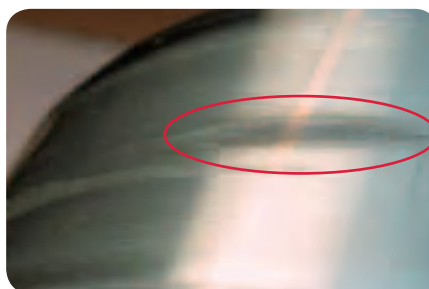
粘着磨损 圆柱滚子轴承内圈滚道上的粘着磨损
