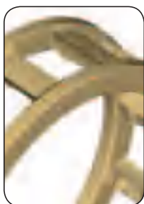
整体式机加工黄铜保持架，外圈引导，型号后缀ML
