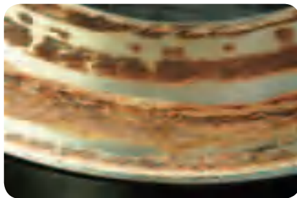
摩擦磨蚀 轴承孔中的摩擦磨蚀
