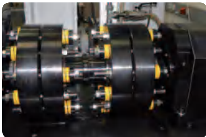
带有两组、每组四个轴向加载陶瓷角接触球轴承的耐久性寿命测试装置
