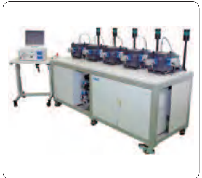
用于确定最适宜润滑脂质量的SKF润滑脂测试装置
