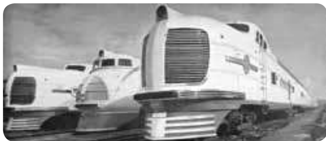
二十世纪三十年代起的美国联合太平洋铁路列车采用SKF的牵引电机圆柱滚子轴承，每台牵引电机的额定功率平均为220 kW 来源：Das Kugellager (SKF) 1939 - 2, 第18页
