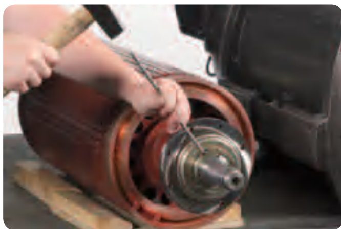
第8步：折弯锁定垫圈之一来固定锁定螺母
