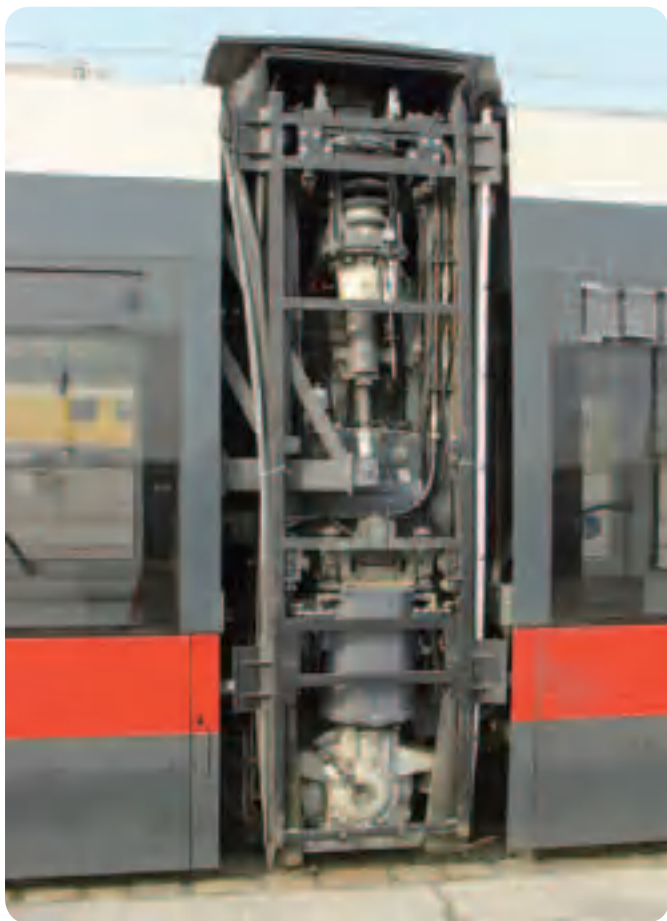
用于低地板轻轨车辆的单车轮系统的竖直传动系统
