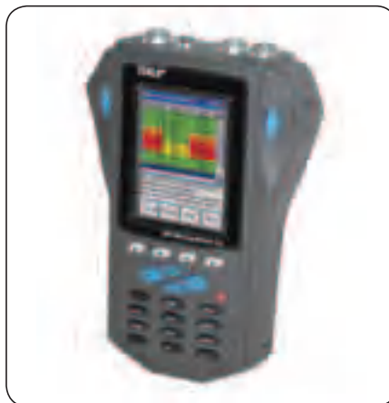
SKF Microlog CMXA 小屏幕采用0.16 Hz至40 kHz的频率范围, 分辨率高达25 600行
