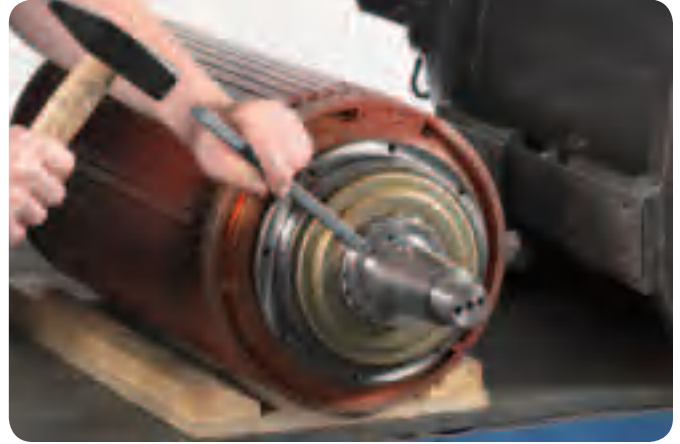
第5步：折弯锁定垫圈之一来固定锁定螺母
