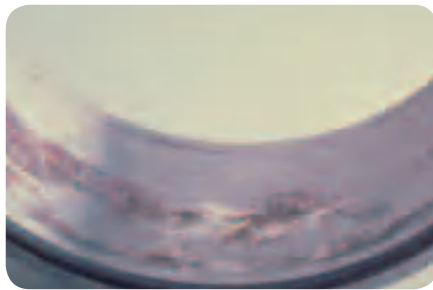
摩擦磨蚀 轴承孔中的摩擦磨蚀，由配合不充分引起
