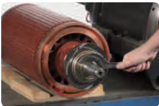
第7步：在轴向上使用锁定螺母固定TMBU
