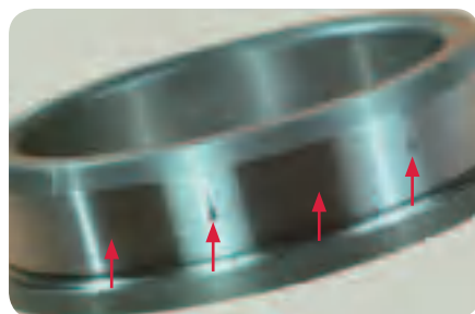
圆柱滚子轴承的内圈- 由于错误安装引起 的人为压痕
