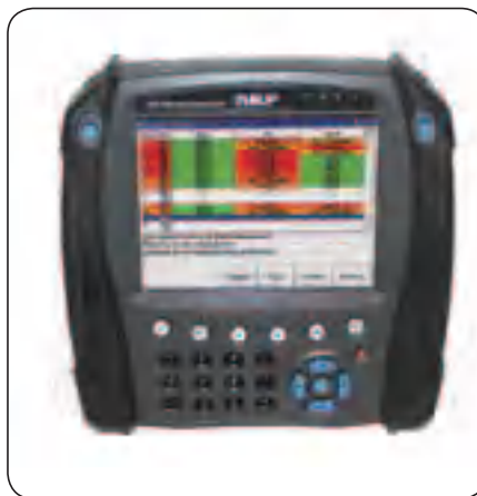
SKF Microlog CMXA 大屏幕采用0.16 Hz至80 kHz的频率范围, 分辨率高达25 600行
