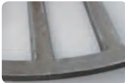
磨粒磨损 圆锥滚子轴承钢保持架上的磨料磨损
