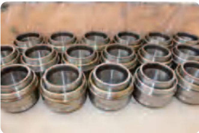
牵引电机轴承单元的再制造 拆卸的轴承，内圈装配可供清洁前检查润滑脂状态
