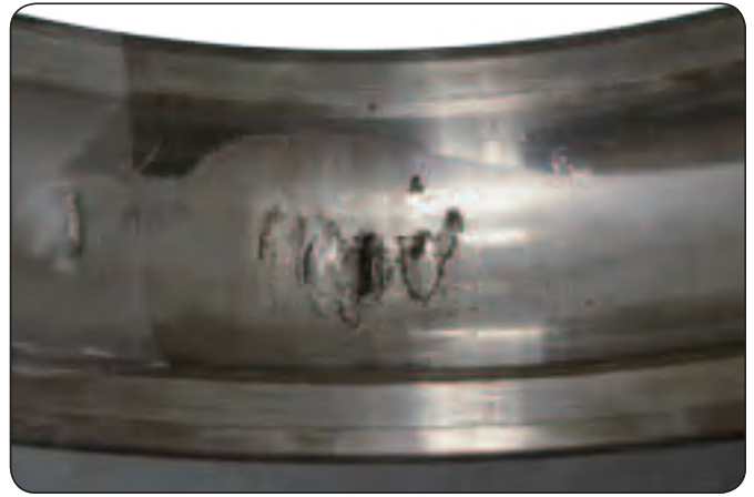
过电压 产生较大剥落的球轴承滚道
