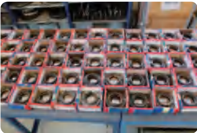
牵引电机轴承单元的再制造 拆卸的轴承、带保持架的外圈以及滚子装配，从而可供清洁前检查润滑脂状态
