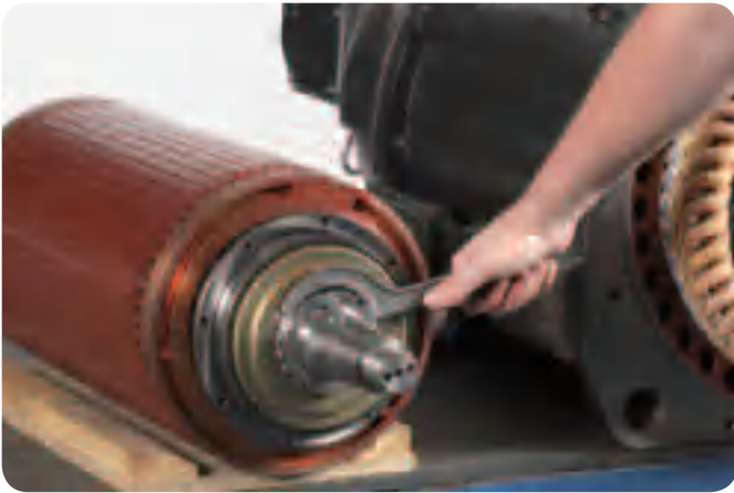
第4步：在轴向上使用锁定螺母固定TMBU
