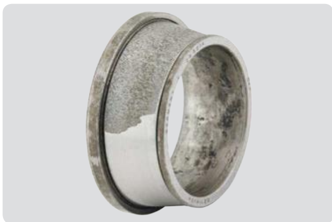
圆锥滚子轴承内圈 润滑膜不足, 导致大面积表面疲劳。
