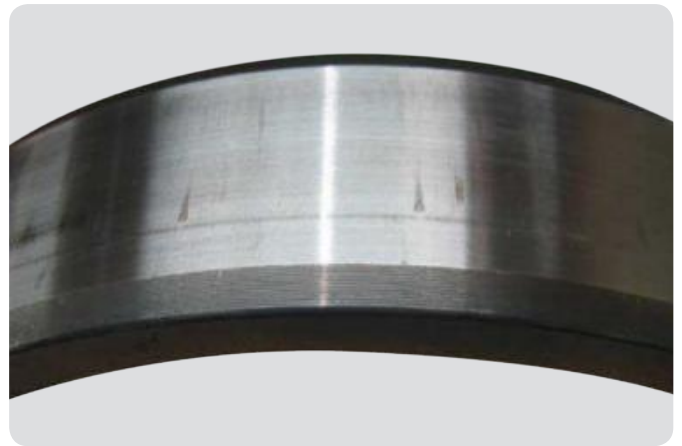
圆柱滚子轴承内圈 安装过程中, 内圈和外圈没有正确对中。在滚动体表面有轴向痕迹。
