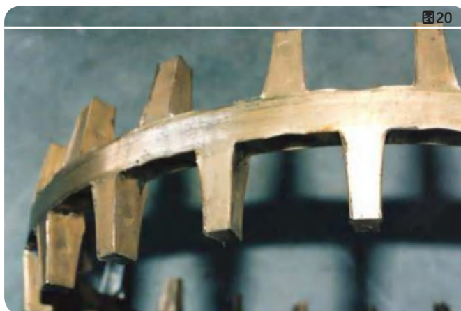
保持架： 保持架兜孔严重磨损
