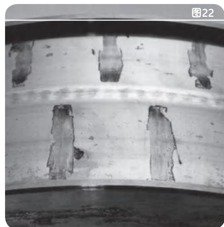
球面滚子轴承内圈滚道上滚动体节圆处的初始蚀刻斑点
