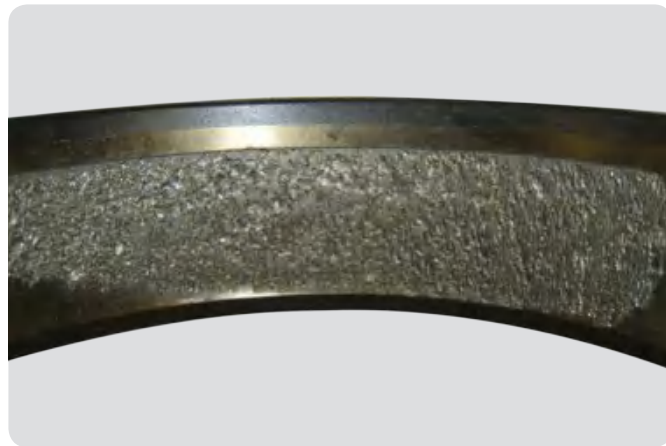
圆柱滚子轴承外圈 润滑膜不足, 存在对中误差, 导致晚期表面疲劳。
