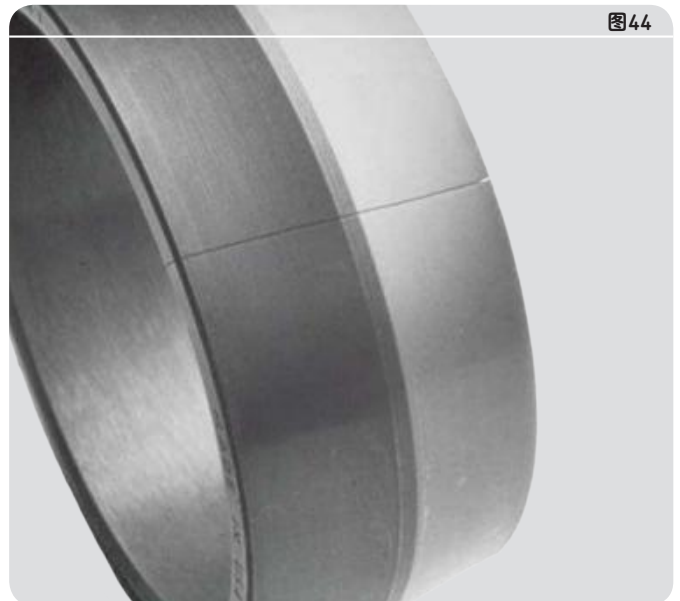
推进量过大引起的圆锥孔球面滚子轴承内圈断裂
