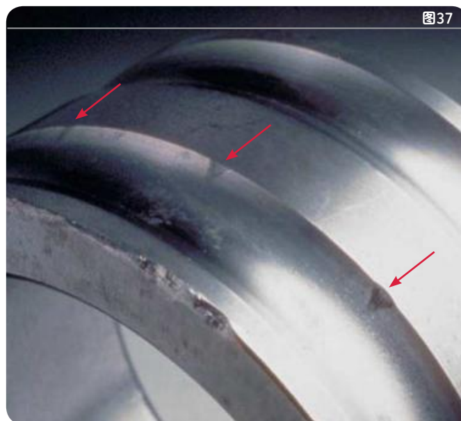
因安装方法不正确引起的双列角接触球轴承滚道上等钢球间距的压痕
