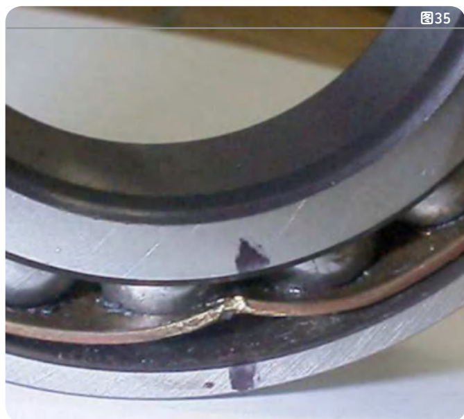
因操作不当引起的角接触球轴承保持架塑性变形
