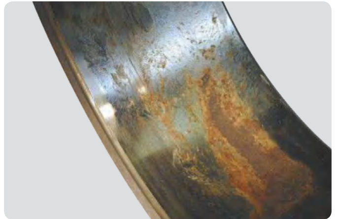
圆柱滚子轴承内圈 轴配合不当, 支撑不均匀。
