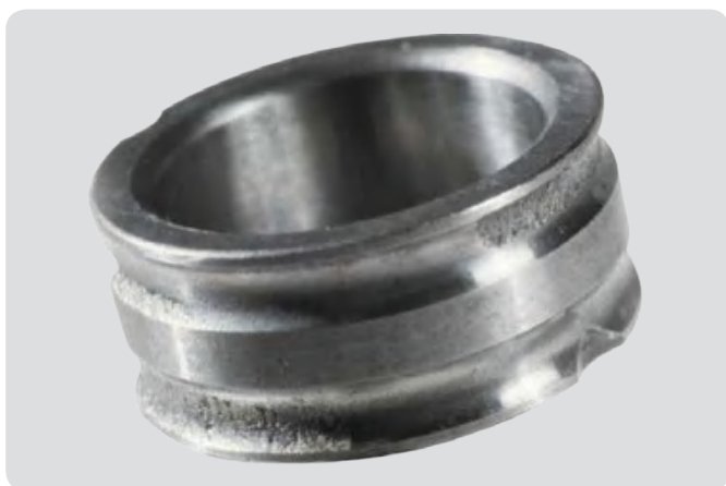
双列角接触球轴承内圈 对中误差过大, 导致载荷过大, 两个载荷区180°分离。
