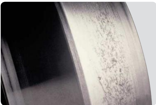
球面滚子轴承内圈 载荷过低加上润滑不足
