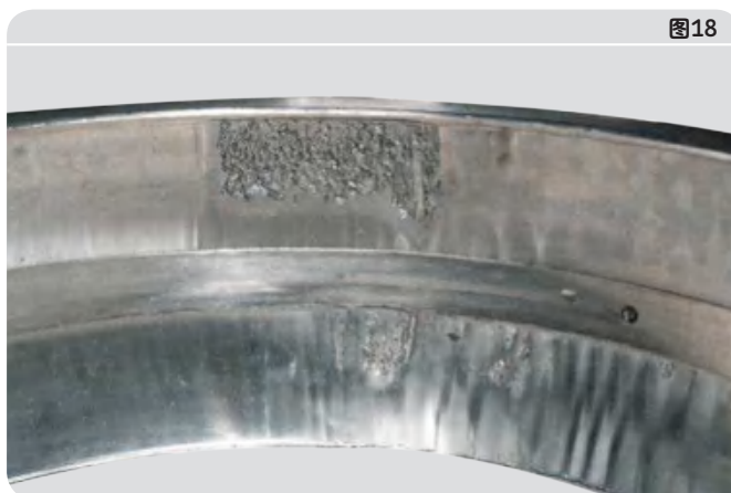
外圈： 滚道表面载荷区的剥落和振动痕迹（外圈底部）
