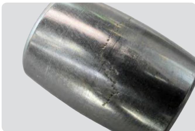
球面滚子轴承 — 滚子 电流过大造成大量“之”字形放电痕。
