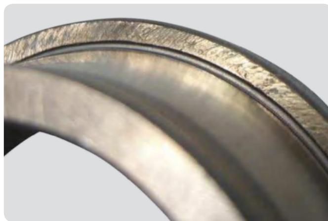
圆锥滚子轴承内圈 污染和润滑不足导致法兰粘着磨损以及滚道发亮
