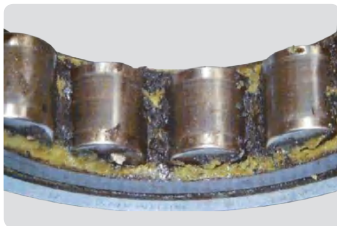
圆柱滚子轴承外圈以及保持架、滚子和润滑脂 电流泄漏导致保持架梁上的润滑脂烧焦变黑。
