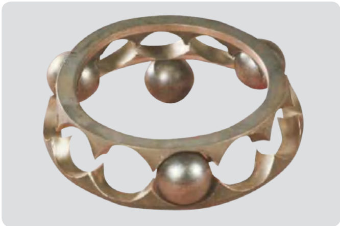
角接触球轴承保持架 润滑不足和振动导致保持架槽研磨磨损。保持架梁磨损。
