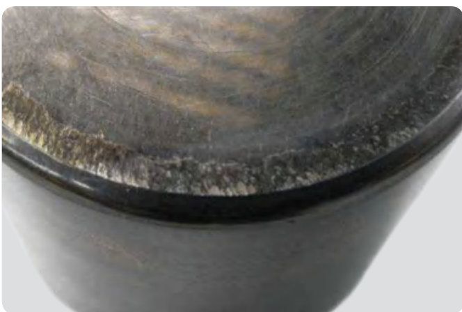
圆锥滚子轴承—滚子 污染和润滑不足导致大滚子端面上出现粘着磨损痕迹。
