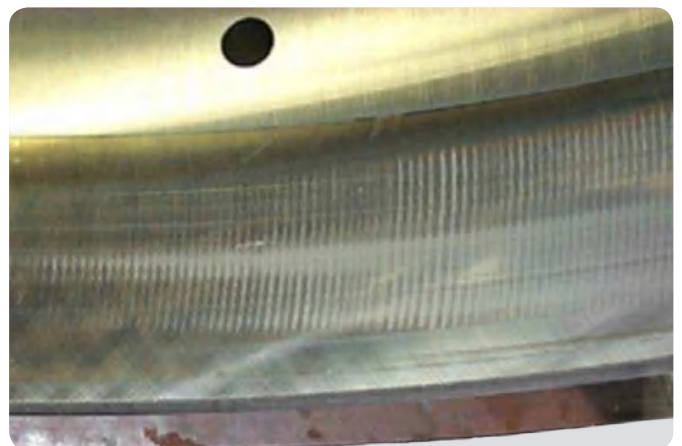
球面滚子轴承外圈 电流泄漏。
