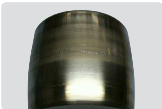
球面滚子轴承 — 滚子 电流过大造成大量念珠状放电痕。
