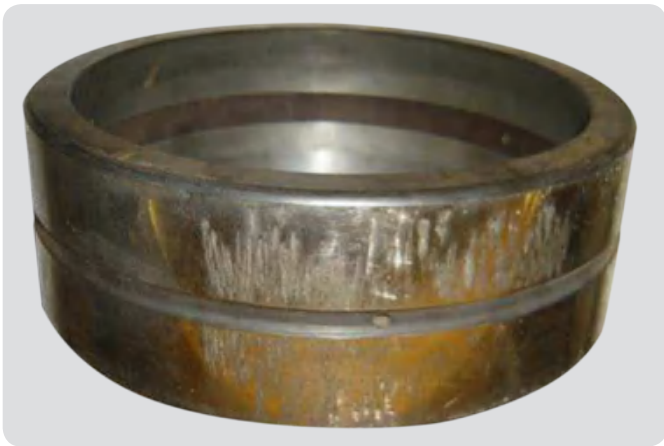
球面滚子轴承外圈 晚期滚道剥落引起的微动导致的棕色微动腐蚀区域，以及拆卸引起的刮痕。
