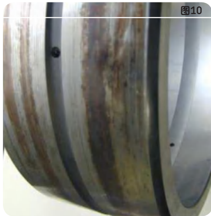
外圈: 外径蠕蚀腐蚀
