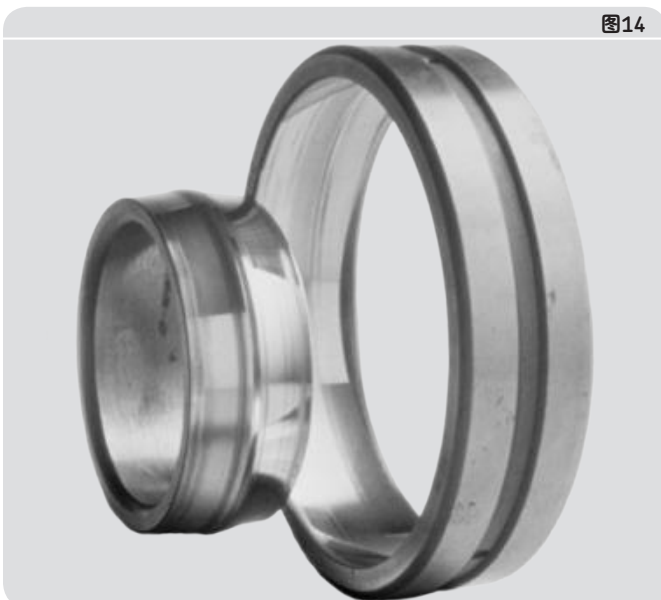
球面滚子轴承内外圈上的磨光磨损(镜面滚道表面)
