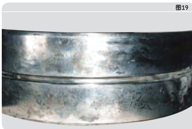
外圈： 外表面载荷区的严重微动腐蚀
