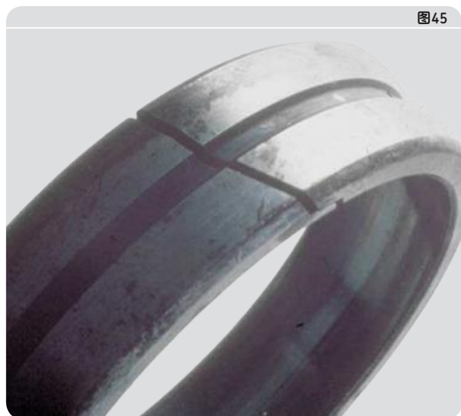
球面滚子轴承外圈上的疲劳断裂
