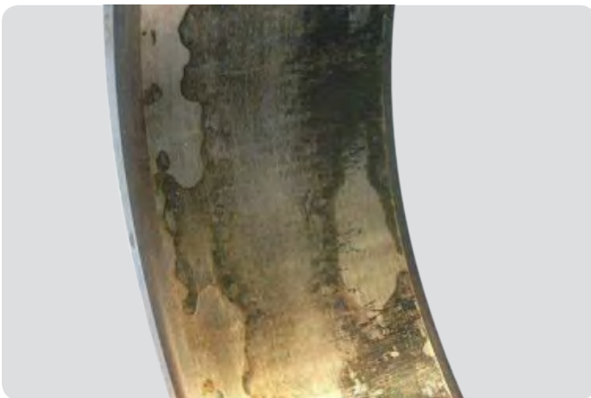
圆柱滚子轴承内圈 轴配合不当, 支撑不均匀。
