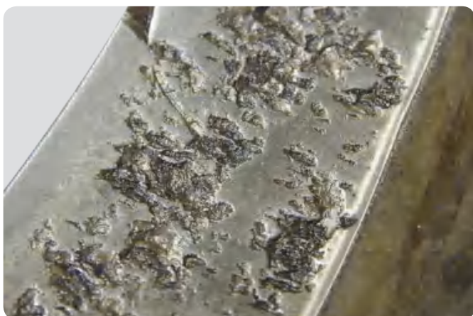
球面滚子轴承外圈 最初是污染产生磨损, 后来发展成为表面疲劳和晚期剥落。
