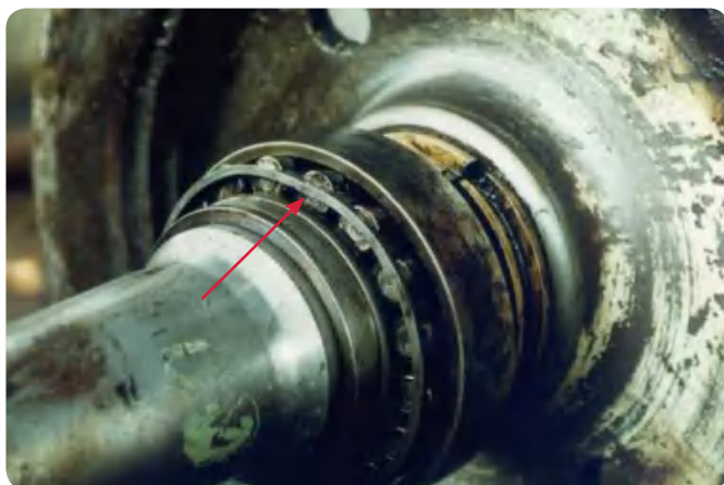
安装在火车轮对上的圆锥滚子轴承
