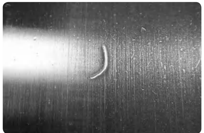
球面滚子轴承外圈 不断碾压切屑/碎屑将导致剥落。
