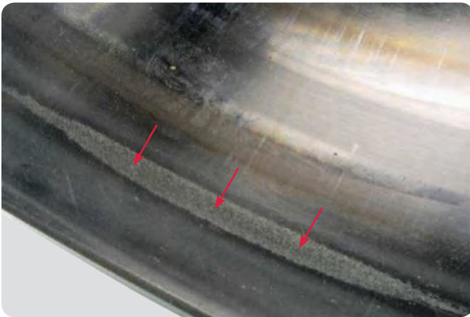
球面滚子轴承外圈 早期损坏: 存在小且浅的放电痕的暗灰区域。
