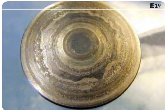
球面滚子推力轴承滚子推力面的拖尾
