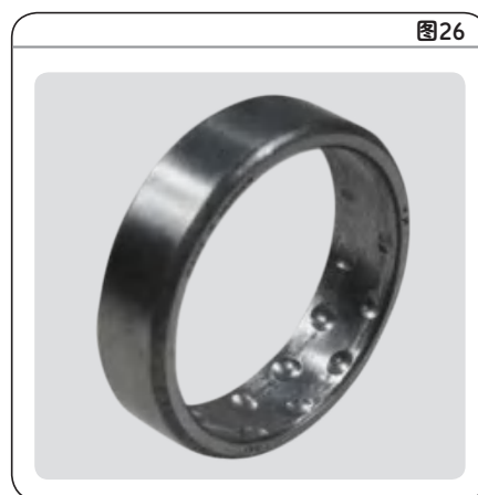
图26 自调心滚子轴承外圈滚道上严重的微振腐蚀造成的损坏
