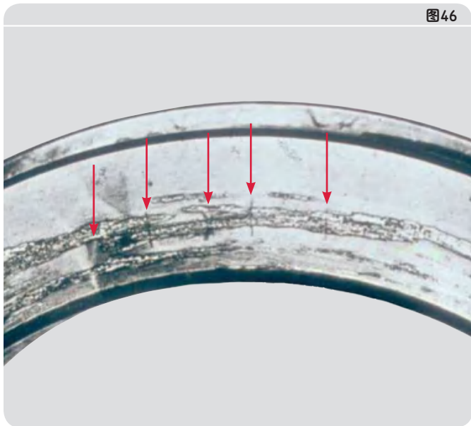
圆锥滚子轴承内圈端面的横向热裂纹
