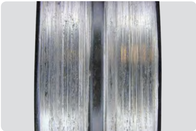
球面滚子轴承外圈 配合不充分造成轴承座跑圈——外表面出现研磨磨损痕迹。
