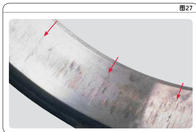
圆柱滚子轴承外圈滚道上的微振腐蚀造成的损坏 (“凹槽”)
