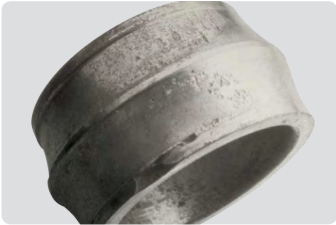
球面滚子轴承内圈 污染及其导致的润滑不足造成的滚道研磨磨损——一个滚道由于轴向载荷损坏更加严重。
