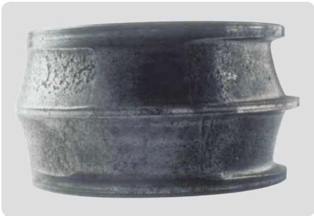
球面滚子轴承内圈 内圈静止——严重的研磨磨损——两处磨损区域：一处区域磨损严重；然后内圈滑动，形成第二处磨损区域。
