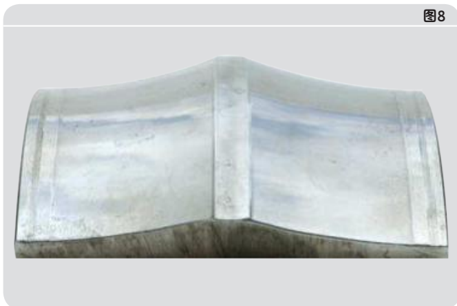
内圈：滚道表面出现严重磨粒磨损，两侧滚道边缘出现环形槽
