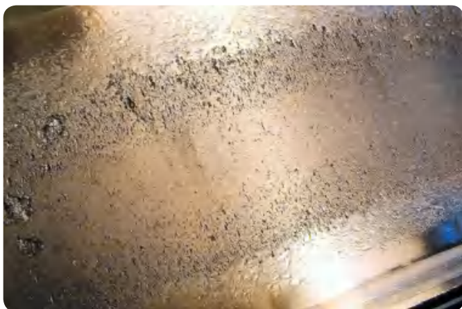
球面滚子轴承内圈 润滑不足, 表面疲劳, 早期剥落
