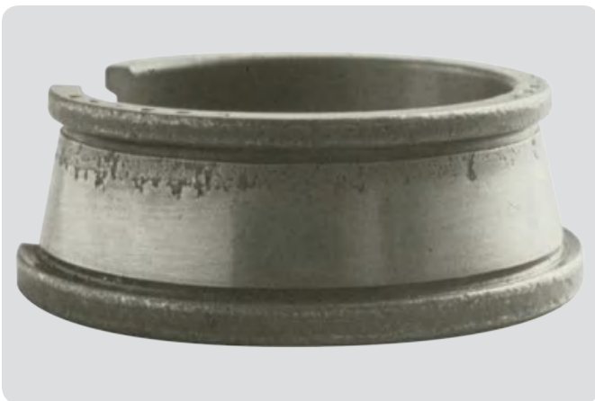
圆锥滚子轴承内圈 对中误差和随之发生的边部偏载导致仅在滚道一侧出现剥落,进而导致更高应力和轴承失效。
