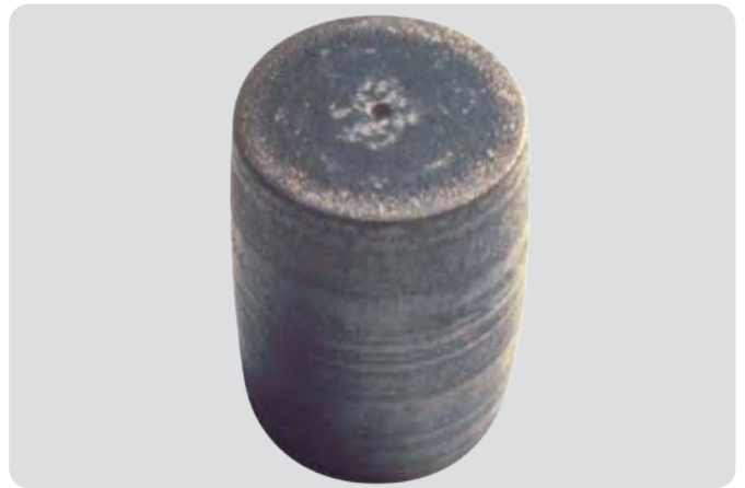
球面滚子轴承—滚子 大量水渗入轴承，导致滚子腐蚀。
