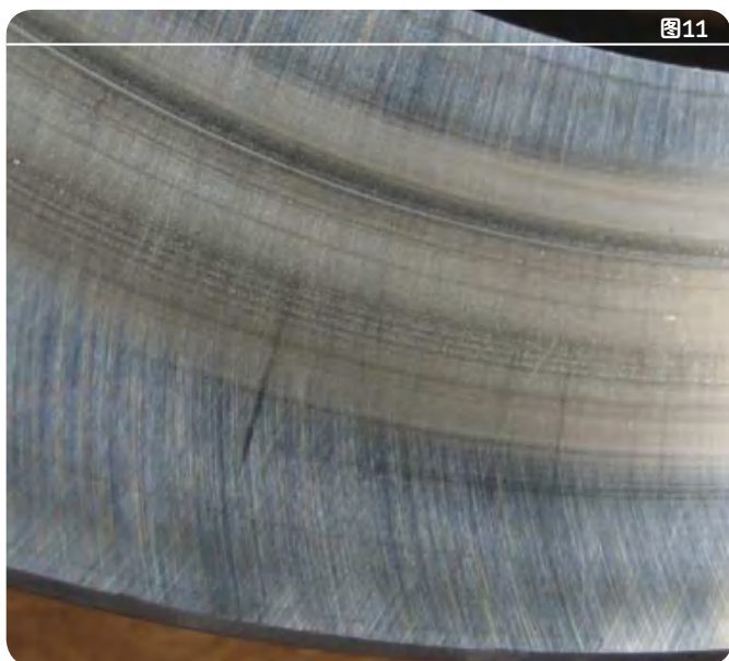
球面滚子推力轴承外圈的轻微磨粒磨损
