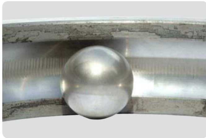
深沟球轴承外圈和滚珠 外圈皱缩和滚珠表面暗淡。
