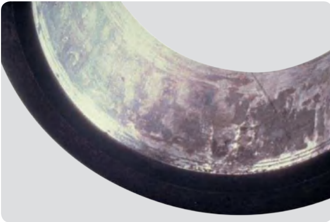
圆柱滚子轴承内圈 轴配合不当 (过松)。
