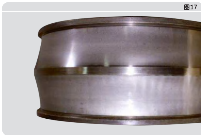
内圈： 滚道表面的磨粒磨损
