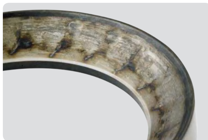
球面滚子推力轴承外圈 最初是粘着磨损，然后产生过多热量，最终卡死。
