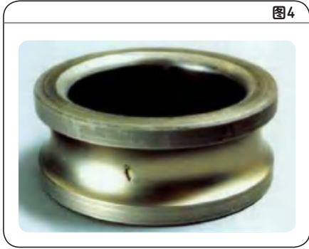
深沟球轴承内圈的初始次表面剥落
