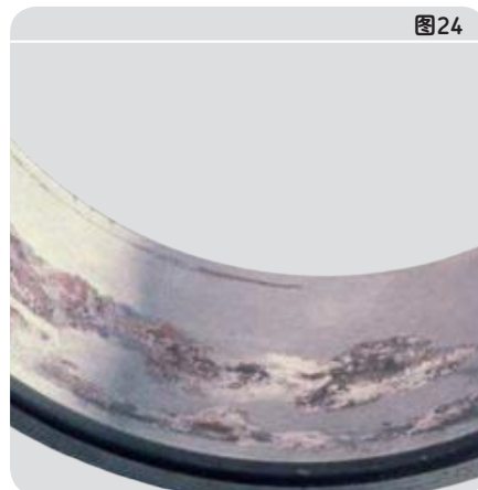
因轴颈不当或轴弯曲引起的内圈内孔蠕动腐蚀
