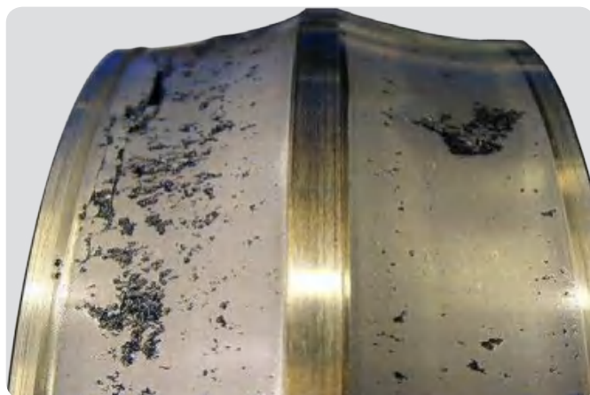
球面滚子轴承内圈 润滑膜不足。最初是污染导致磨损, 后来发展成为表面疲劳和剥落。
