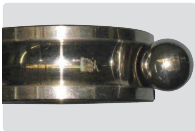
深沟球轴承内圈和滚珠 电流过大造成滚珠和滚道上出现许多“之”字形放电痕。
