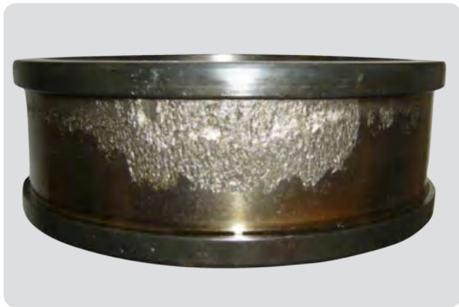
圆柱滚子轴承内圈 润滑膜不足, 对中误差过大, 导致晚期表面疲劳。
