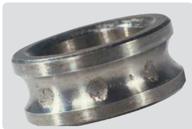
深沟球轴承内圈 安装过程中的冲击导致滚珠节圆处发生剥落。
