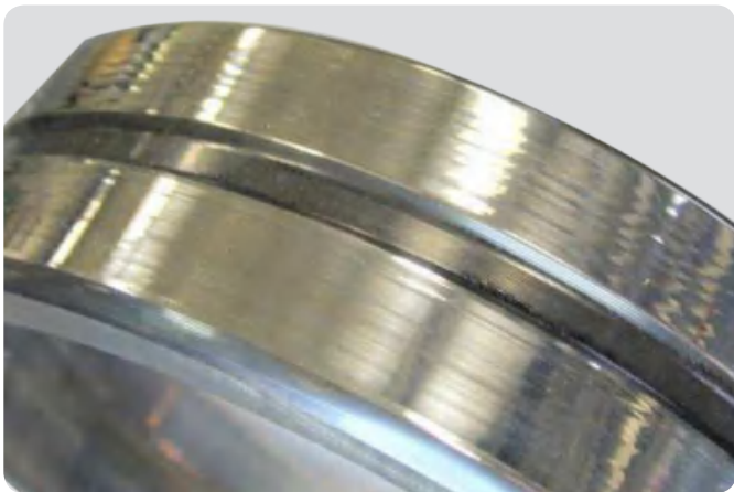
球面滚子轴承外圈 配合不充分造成轴承座跑圈——外表面出现磨光磨损痕迹。
