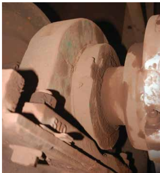
图 20. 图中所示的是钢铁行业应用场合中使用的 Timken 剖分式带座圆柱滚子轴承单元
