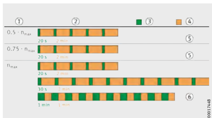
图 4 开式和密封式的主轴轴承匀脂工艺
