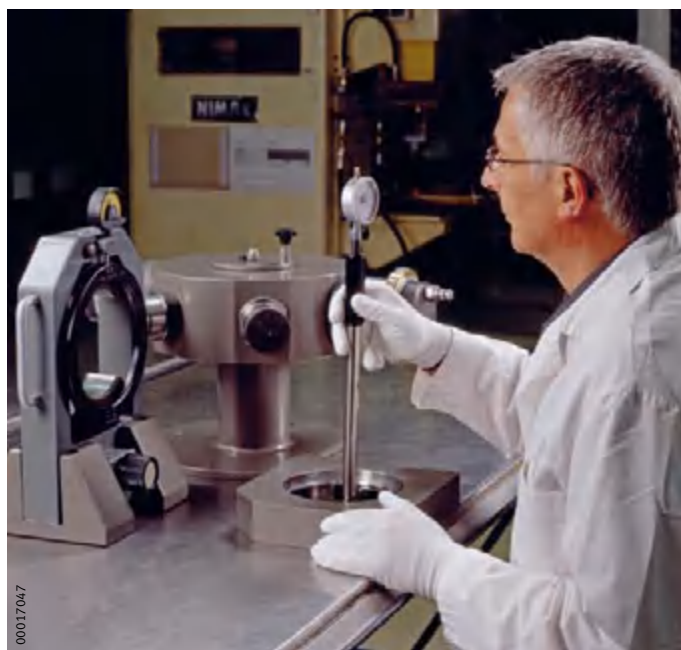
图 2 测量外圈的滚道直径
