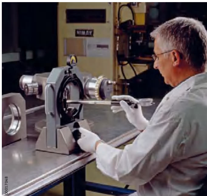
图 3 将测得的直径传递给包络圆量规
