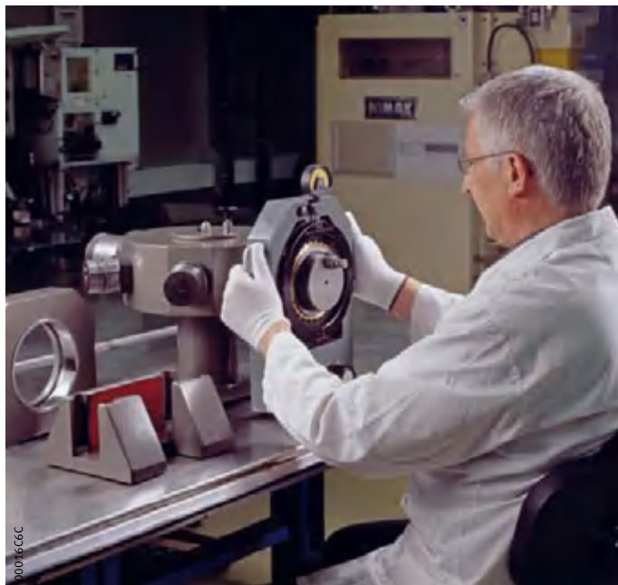
图 4 包络圆量规的位置调整
